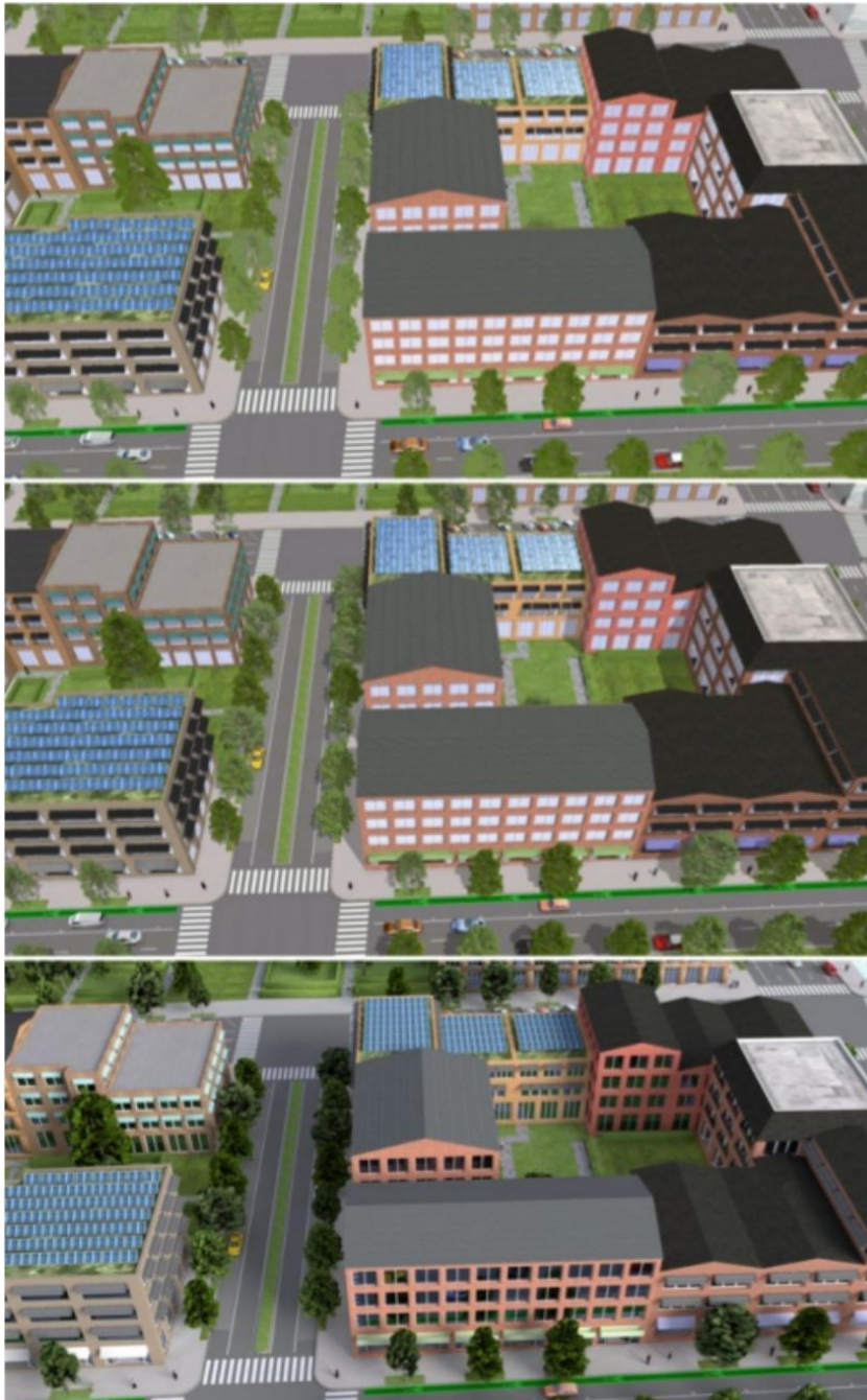
شکل ۱۷. قسمت بالایی: پرداخت صحنه (رندر) بیدرنگ OpenGL CityEngine بدون انسداد محیطی یا سایه. قسمت وسطی: نمایی همراه با انسداد محیطی و سایه. قسمت پایینی: رندر Blender' Cycles ۱۲ دقیقه طول می کشد تا این تصویر را با قسمت های سایه روشن و شیشه انعکاسی ارائه دهد. شبکه با فرمت OBJ به Blender صادر شد.
